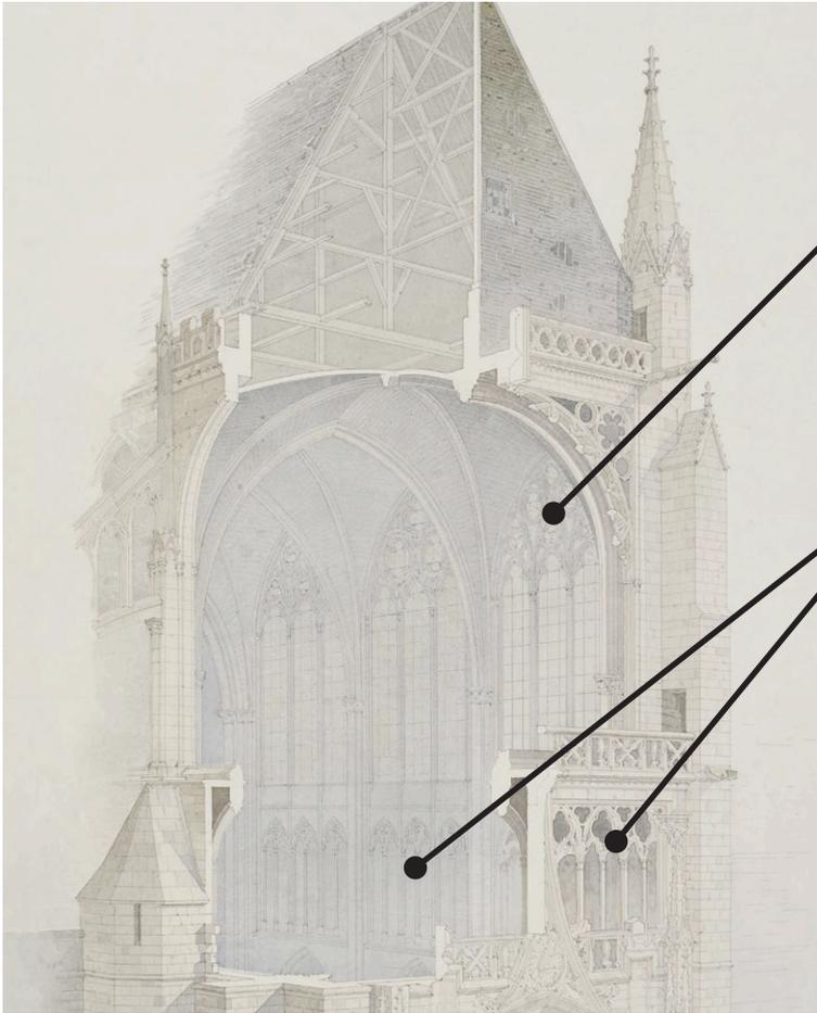
Le remplage\* en réseau apparaît sur les édifices du début du 13<sup>e</sup> siècle. L'utilisation de pierres armées\* permet un amincissement du volume de pierre et réciproquement une augmentation de la surface vitrée. Ce dispositif assure aussi une meilleure rigidité des verrières.
